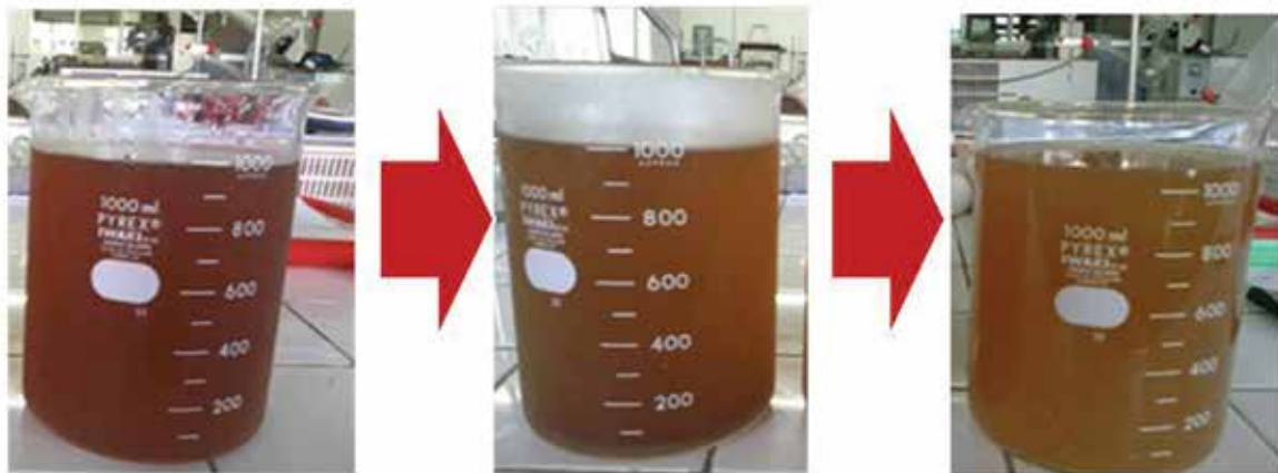
Gambar 5. Sampel air limbah sebelum dan setelah pengolahan (Nilai COD berturut-turut dari kiri ke kanan = 600 mg/L, 300 mg/L, 150 mg/l).
