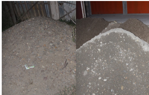
Gambar 1 Material sirtu pada dua lokasi pembangunan ruko di Kota Lhokseumawe
