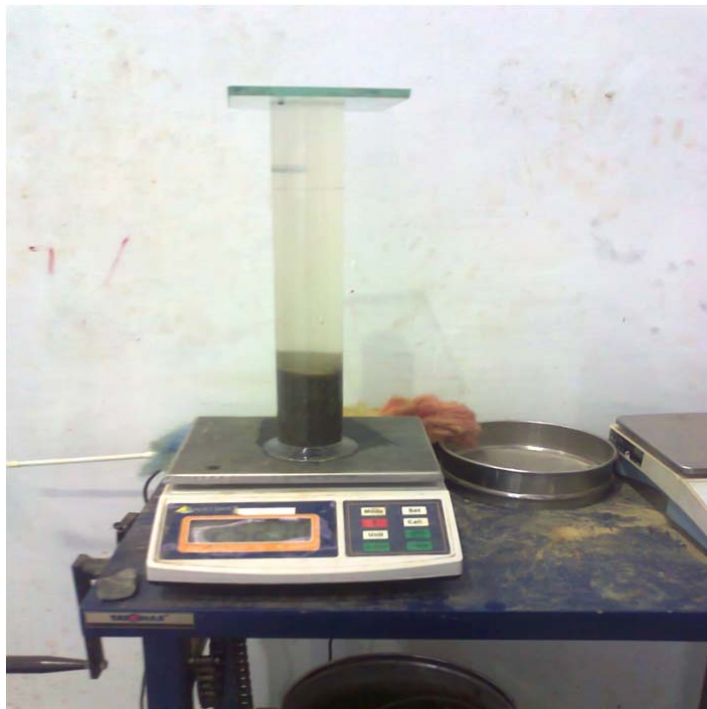
Gambar D.5 Penimbangan agregat halus dalam piknometer untuk pengujian absorpsi agregat halus
