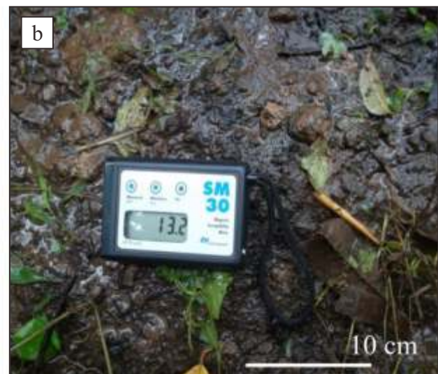
Gambar 4. (a) Singkapan aliran piroklastika dan (b) pengukuran suseptibilitas magnetik untuk batuan yang tersingkap di lapangan dengan magnetic susceptibility meter SM-30.
