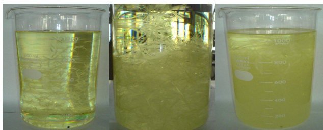
Gambar 6. Proses pembentukan kristal ketika distilat fraksi metil sinamat diberi bibit kristal
