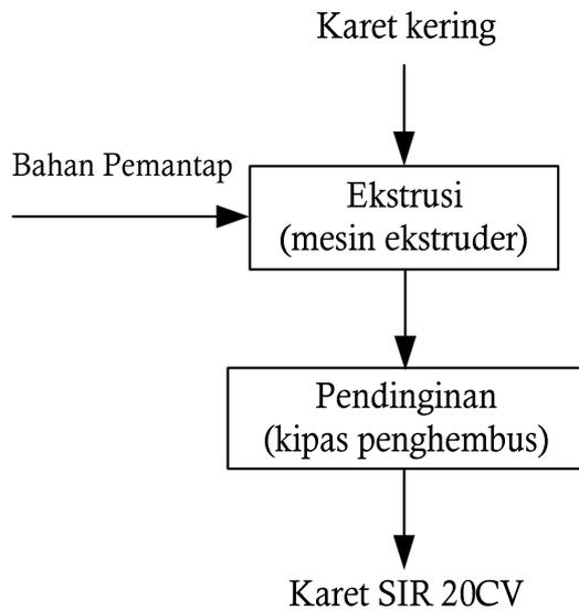
Gambar 3. Diagram alir pembuatan karet SIR 20CV
