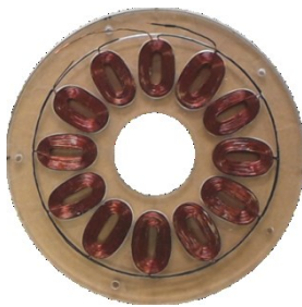
Gambar 12. Konstruksi stator generator dengan 12 lilitan kumparan
