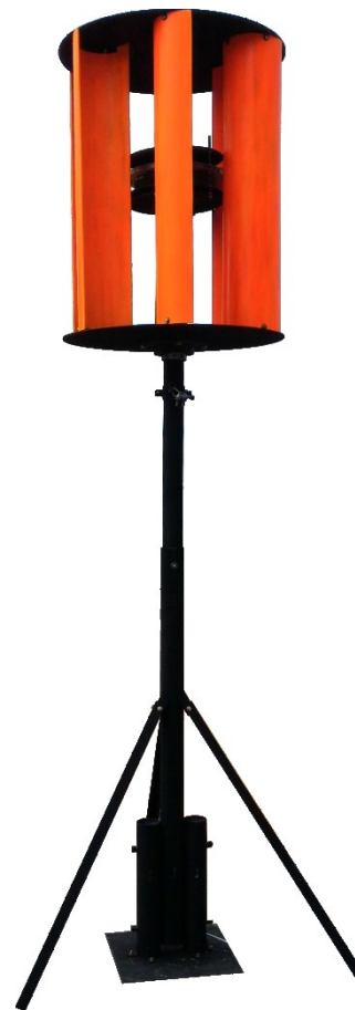
Gambar 15. Konstruksi hasil perakitan kincir angin dan generator magnet permanen dengan tiang penyangga
