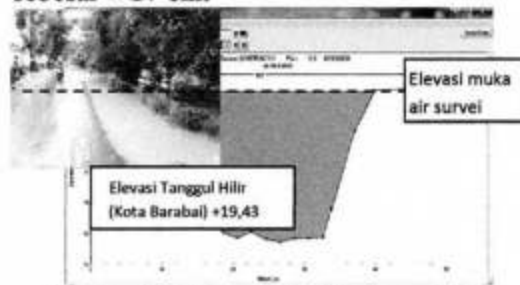
Gambar 13. Survei dan Hasil analisis Profil Muka Air pada Patok H49
