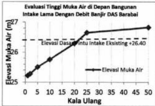
Gambar 11. Grafik Hubungan Elevasi Muka Air di Depan Bangunan Intake eksisting dengan Debit Banjir DAS Barabai.
