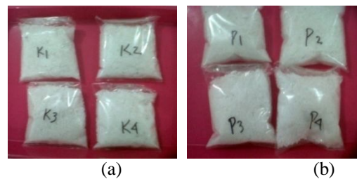
Gambar 8. Kristal garam konsumsi beryodium tanpa pemurnian (a) dan dengan pemurnian (b)
