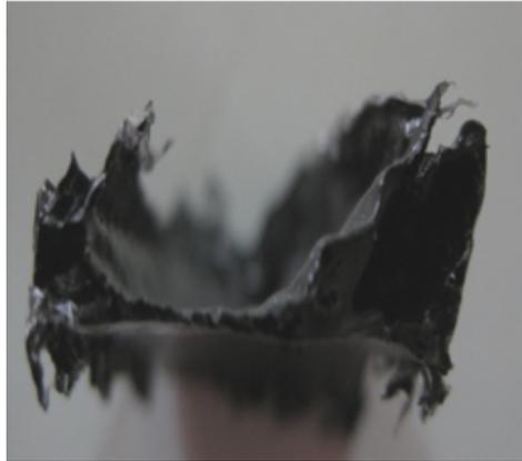
Gambar 7. Foto makro rongga pada komposit metode cetak tebal
