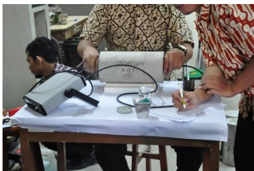
Gambar 3. Pengujian UPV pada spesimen
