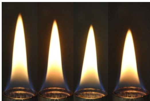
Gambar 7. Pola api bunsen burner minyak jarak pagar
