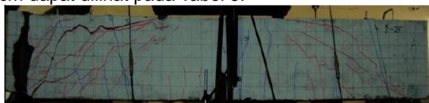
Gambar 5. Pola kehancuran balok beton ringan busa pozzolan pada jarak sengkang 25cm (sumber: hasil analisis,2015)
