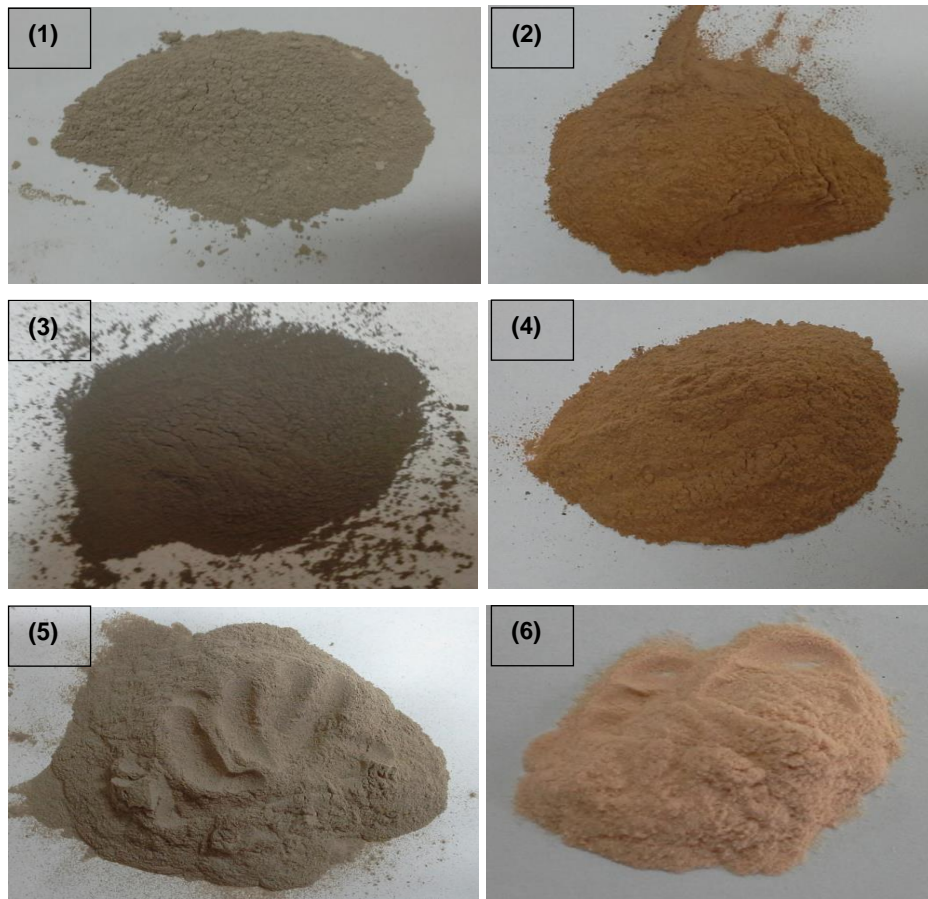
Gambar 5. Abu yang lolos ayakan 0,1 mm (1) PBA tanpa sintering ; (2) PBA sintering ; (3) PFA tanpa sintering ; (4) PFA sintering ; (5) RHA tanpa sintering ; (6) RHA sintering
