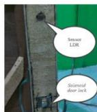
Gambar 23. Posisi Sensor LDR dan *Solenoid Door Lock*
