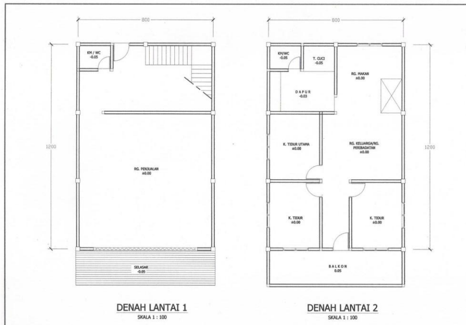
Gambar 6 Denah Bangunan Pecinan Sistem Ruko pada Umumnya
