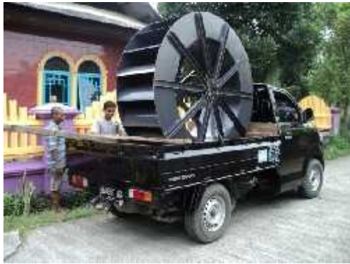
Gambar 1. Ukuran kincir konvensional yang besar dan dibuat utuh (tidak dapat diurai) menjadi kendala saat pengangkutan ke lokasi mitra/pengujian.
