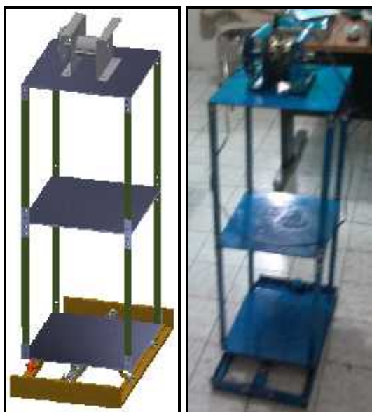
Gambar 3. Model dan bentuk alat uji model getaran struktur dengan sistem motor yang memutar disk dengan unbalance mass ditempatkan pada Massa-3
