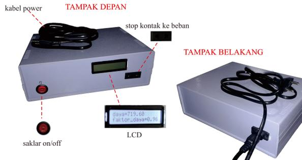
Gambar 4. Alat Perbaikan Faktor Daya
