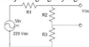
Gambar 3. Rangkaian Resistor Pembagi Tegangan
