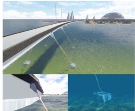
Gambar 4. Sistem angker yang diterapkan pada J3F
