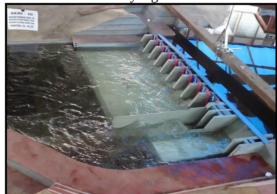
Gambar 9. Kondisi Aliran Pada Hilir Barrage Tampak Samping
