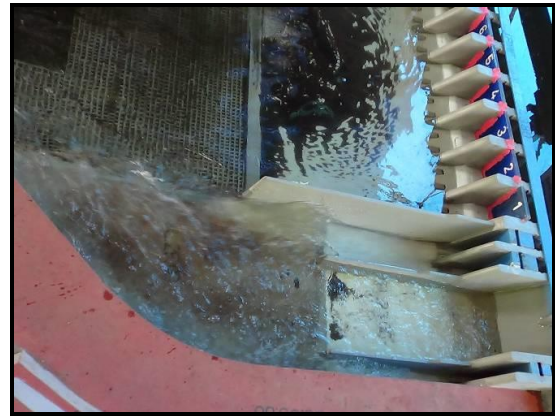
Gambar 7. Kondisi Aliran Pada Saat Elevasi Hulu Barrage +42,35
