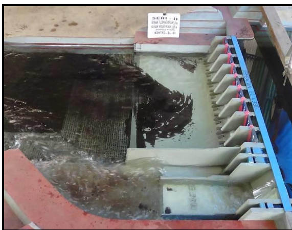
Gambar 6. Kondisi Aliran Pada Saat Elevasi Hulu Barrage +41,00
