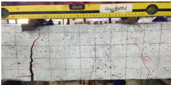
Gambar 11. Pola retak balok beton bertulangan bambu dengan kait jarak 2,5 cm
