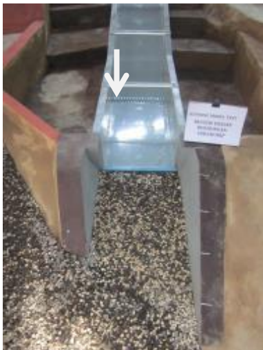
Gambar 9. Kondisi peredam energi di model fisik hidraulik
