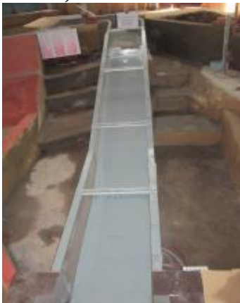
Gambar 8. Kondisi saluran peluncur di model fisik hidraulik
