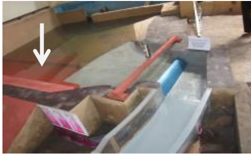
Gambar 5. Kondisi daerah tampungan bendungan di model fisik hidraulik
