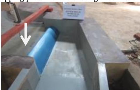
Gambar 6. Kondisi pelimpah di model fisik hidraulik
