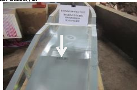
Gambar 7. Kondisi saluran transisi di model fisik hidraulik
