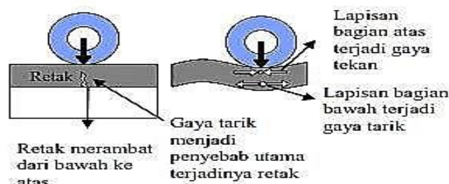
Gambar 1. Mekanisme terjadinya beban tarik dan retakan permukaan
