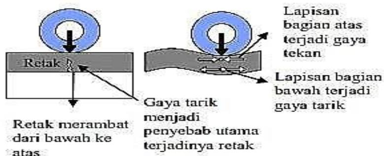
Gambar 1. Mekanisme terjadinya beban tarik dan retakan permukaan
