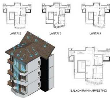
Gambar 13 Balkon rain harvesting Sumber : Dokumen Pribadi
