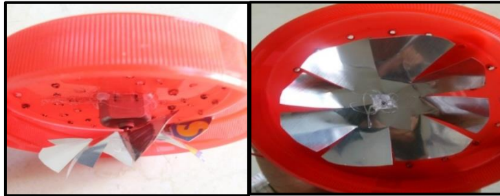
Gambar 2. Proses Pemasangan Dinamo pada Kipas
