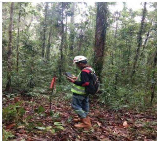
Gambar 2. Penentuan titik bor di lokasi pengeboran
