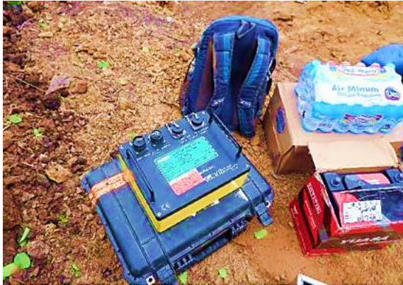
Gambar 3. Switch box dan Accu (Aki)
