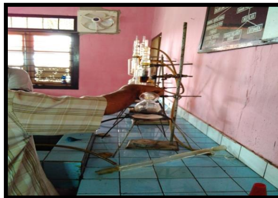
Gambar 7. Pencampuran Sampel Dengan Larutan XYLOL ( C_8H_{10} )
