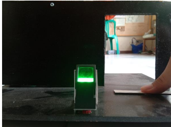
Gambar 14. Hasil Pengujian Limit Switch Saat Ditekan (sumber: dokumen pribadi)
