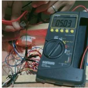
**Gambar 10.** Pengukuran Modul GSM SIM800L
