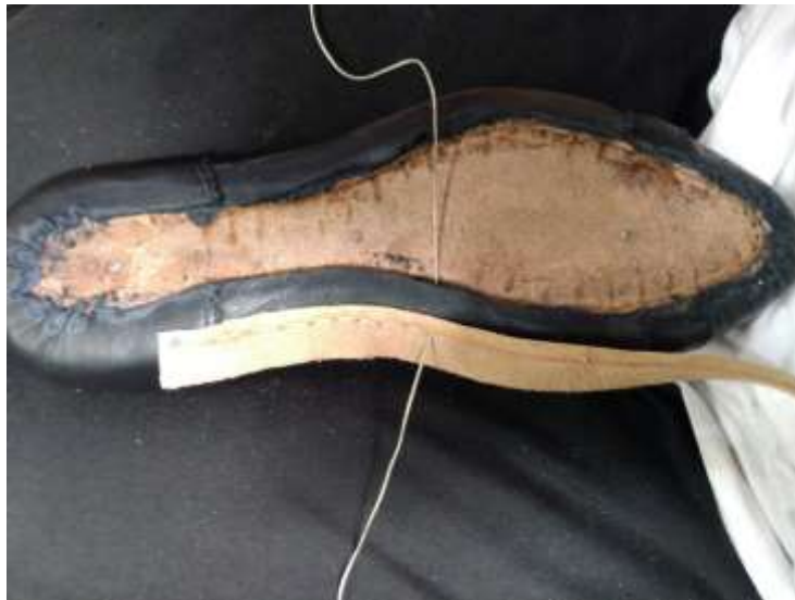
Gambar 10. Proses pemasangan pita
