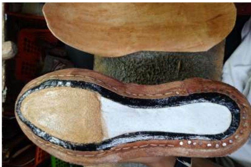
Gambar 11. Filler pada konstruksi hand welted
