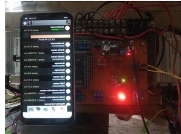
Gambar 14. Kalibrasi Sensor Dengan Bantuan Aplikasi Elixir Pada Hand phone.
