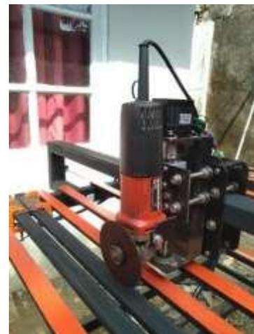
Gambar.16. Rancangan mekanik dengan motor *stepper*
