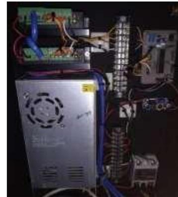
Gambar.15. Kontroler dan *driver* motor *stepper*
