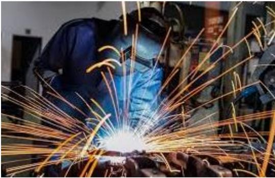
Gambar 1 Proses Pengelasan SMAW
