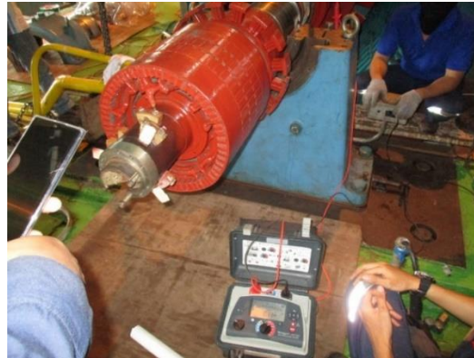
Gambar 11. Proses Pengujian tahanan isolasi setelah perbaikan
