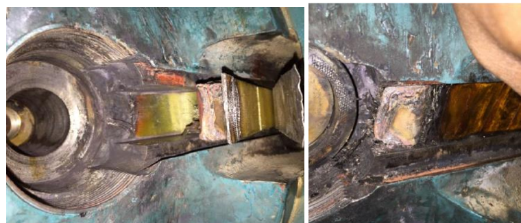
Gambar 9. Kondisi koneksi leadbus pole A putus
