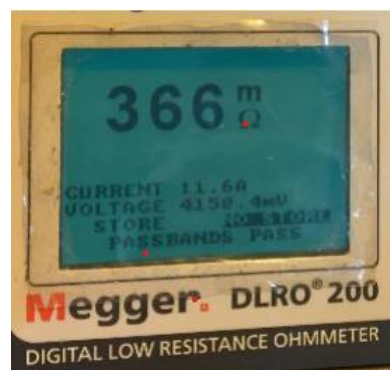
Gambar 12. Pengujian Tahanan Belitan setelah perbaikan
