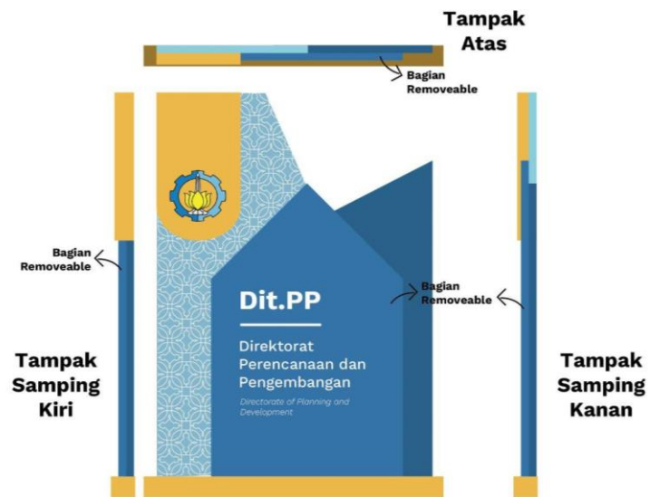
(Gambar 30. Desain Instalasi Signage Penanda Ruang Ukuran Besar (Sumber: Dima, 2022))
