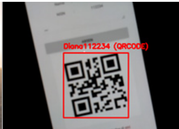
Gambar 5. Pemindaian dengan modul kamera dan Raspberry Pi
