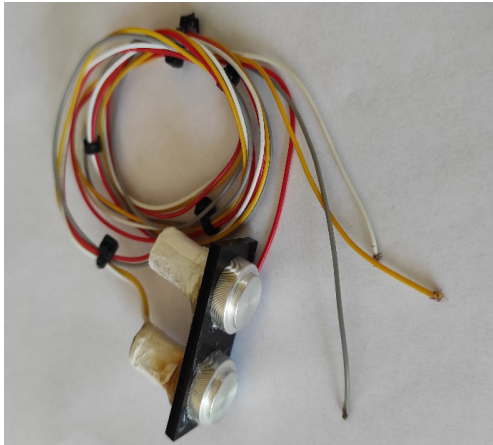
Gambar 5. 16mm waterproof ultrasonic sensor dengan modifikasi
