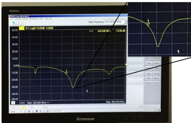
Gambar 6. Grafik return loss Antena Quadrifilar Helix hasil pengukuran untuk frekuensi 433MHz
