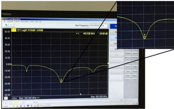
Gambar 5. Grafik return loss Antena Quadrifilar Helix hasil pengukuran
