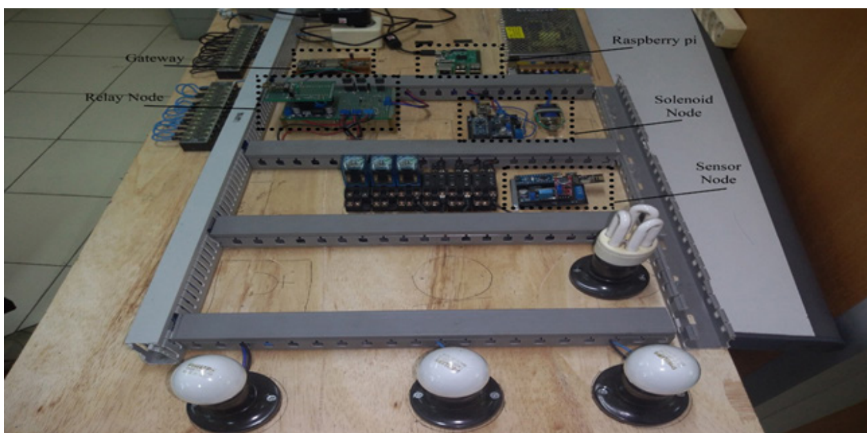
Gambar 3. Desain keseluruhan perangkat keras WSN
