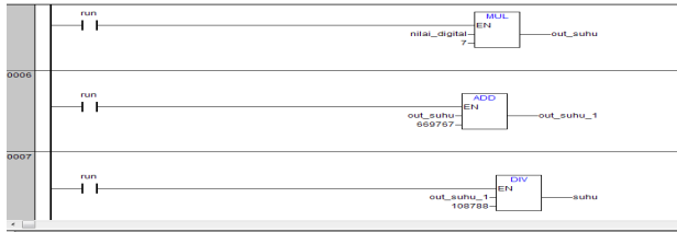
Gambar 17. Tampilan pemrograman ladder diagram untuk pembacaan suhu
