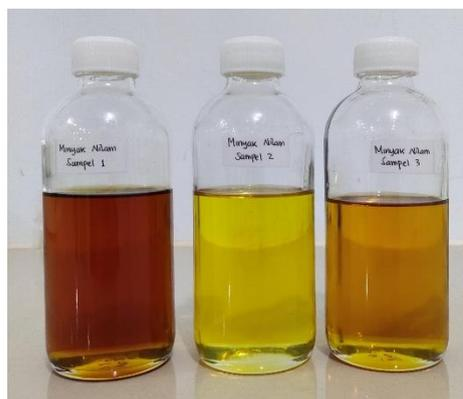
Gambar 1. Minyak nilam penyulingan (1), minyak nilam fraksi ringan (2), minyak nilam fraksi berat (3)
