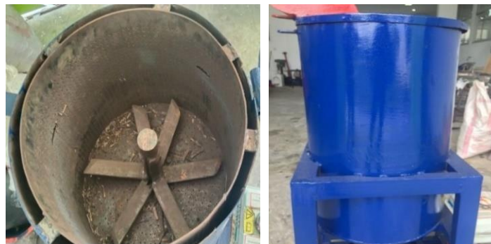
Gambar 4. (a) Tabung dalam (b) Tabung Luar
