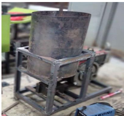
Gambar 3. (a) Rangka mesin pencacah limbah nilam; (b) Motor penggerak bensin Kubota
