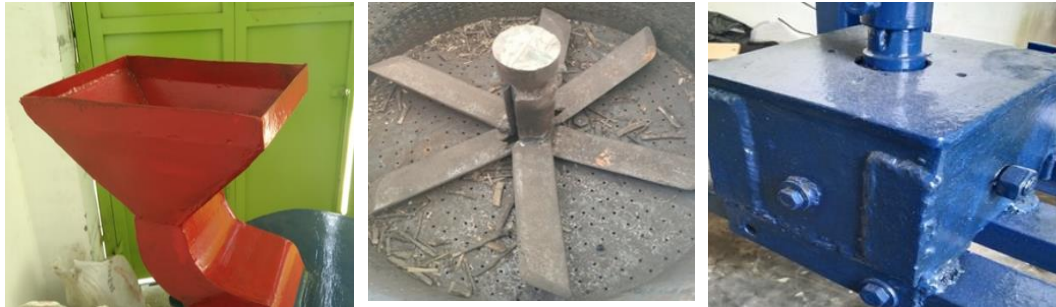
Gambar 5. (a) Hopper ; (b) Mata pisau pencacah; (c) Reduser
