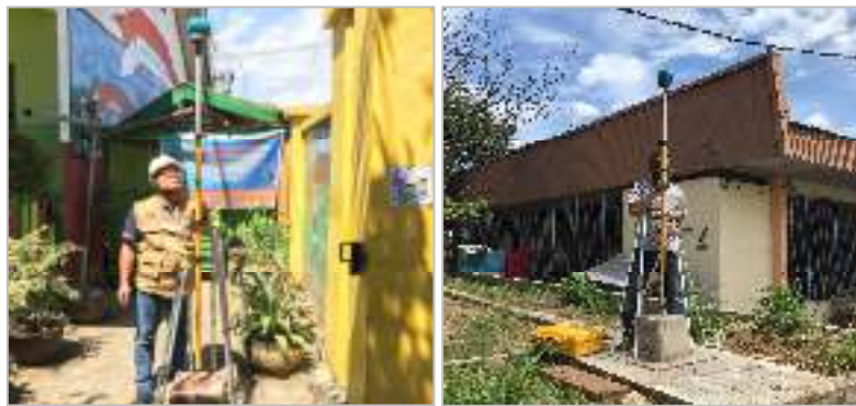
Gambar 3 Pengukuran survey GNSS metode statik
