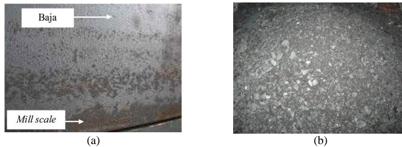
Gambar 1. (a) Mill scale pada baja setelah dilakukan proses hot rolling , (b) Mill scale setelah melalui proses pemisahan ( cleaning ) dari material baja
