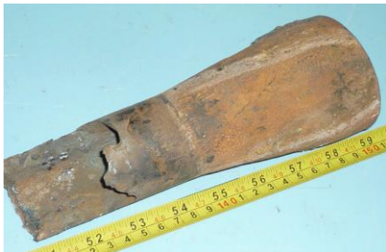
Gambar 5. Pipa radiant section di posisi ekspand No.65 yang retak
