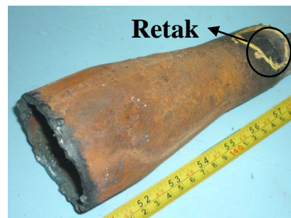
Gambar 2. Pipa No. 66 yang mengalami retak
