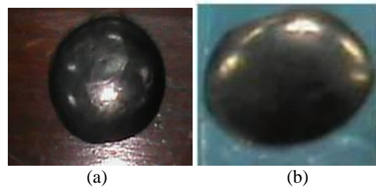
Gambar 2. Visual ingot hasil peleburan untuk ;(a) paduan Zr-2,5Nb dan (b) paduan Zr-2,5Nb-0,5Mo
