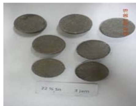
Gambar 10. Foto pellet campuran logam Nb dan Sn sebelum proses pemanggangan
